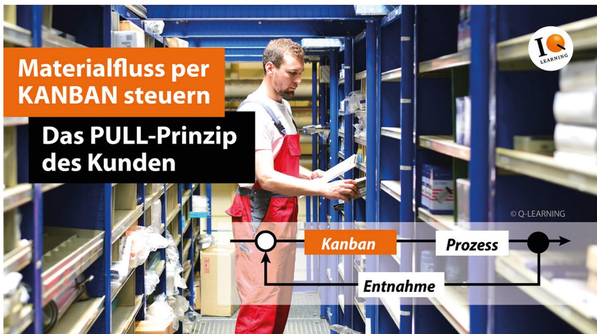
Mit Kanban (= „Signalkarte“) wird Material in Prozessen gesteuert, der Kanban-Regelkreis ermöglicht minimalen Materialumlaufbestand und spart signifikant Kosten
